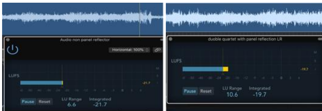
Gambar 9. Ukuran dBFS tanpa papan reflektor (kiri), dan menggunakan papan reflektor (kanan) pada bar time 97 (Dokumentasi: Maria Maya Aristya, 2019)
